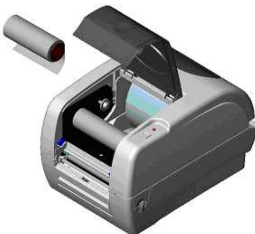
Рис. 5 Установка ленты (II)
