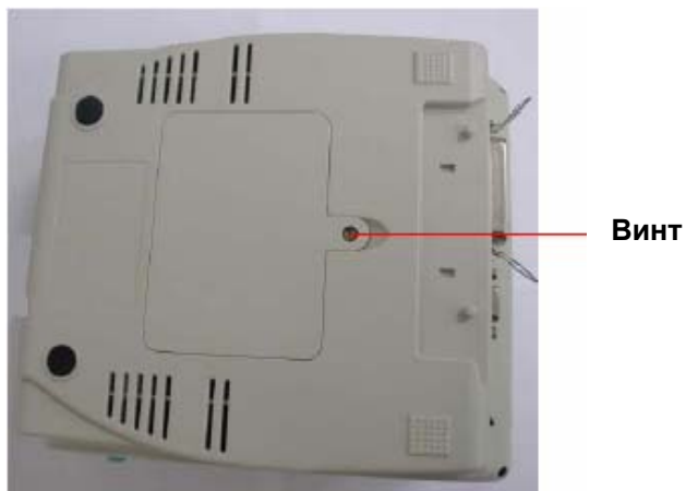
Рисунок 21. Открутите 1 винт с нижней части принтера
