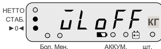
□ Для включения функции взвешивания по допуску нажмите клавишу **T**. На дисплее высветится <WL on>.
