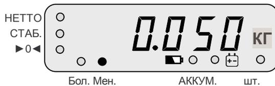
□ Введите нижний предел, используя для изменения значения мигающего разряда клавишу **M**, а для перехода к вводу следующего разряда – клавишу **T** (для некоторых модификаций – клавишу **0**). Допустим, вве-
