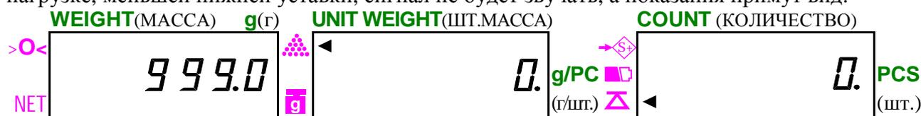
На дисплее **WEIGHT** (МАССА) высвечивается показание текущей массы дозы (здесь: 999,0 г), а на дисплее **UNIT WEIGHT** (ШТ. МАССА) включается указатель
