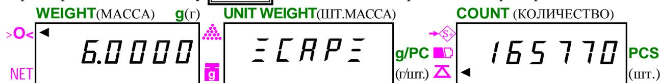
и в заключение нажмите клавишу **ENTER**. На этом юстировочные настройки завершаются и произойдет переход к компенсации нелинейности. На дисплее **COUNT** (КОЛИЧЕСТВО) высветится показание нулевой точки во внутреннем коде, здесь 165770, оно различно для разных моделей и может изменяться в младших разрядах. На дисплее **UNIT WEIGHT** (ШТ. МАССА) условно показан двузначный номер нулевой точки № 00, а на дисплее **WEIGHT** (МАССА) – соответствующая масса в граммах.
