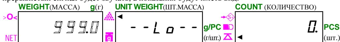
Здесь на дисплее **WEIGHT** (МАССА) высвечивается мигающее показание текущей массы дозы, а на дисплее **UNIT WEIGHT** (ШТ. МАССА) – результат ее сопоставления с уставками, свидетельствующий о том, что текущая масса мала. Это же сообщение дублируется включенным указателем
