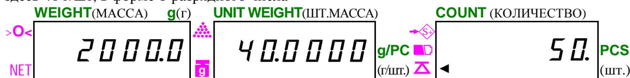
q Если же пауза после ввода последнего разряда или какого-либо промежуточного разряда оказалась дольше, чем время 5 миганий на дисплее **COUNT** (КОЛИЧЕСТВО), набранное число будет зафиксировано на том же дисплее **UNIT WEIGHT** (ШТ.МАССА) в качестве известной штучной массы, здесь 50 г/шт, а на дисплее **COUNT** (КОЛИЧЕСТВО) - соответствующее известной штучной массе значение объема пробы, округленное до целого числа, здесь 40 шт.
