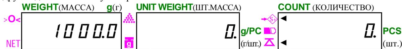
☐ Уберите первый груз с платформы (показание на дисплее WEIGHT (МАССА) обнулится) и положите второй взвешиваемый груз на платформу. Указатель нуля >O< выключится, а стабильности  $\Delta$  - сначала выключится, а затем включится вновь. На дисплее WEIGHT (МАССА) высветится показание массы груза (здесь: 3000,0 г).
