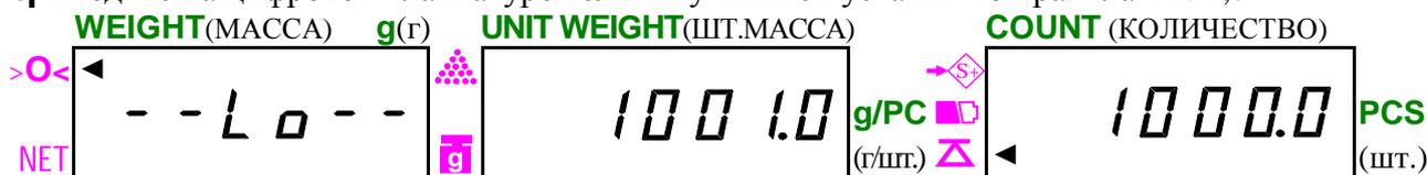
q и нажмите клавишу **U.WT** или **ALARM**. Сначала проверяется, чтобы нижняя уставка была меньше верхней, и если они были введены правильно, на этом процедура их ввода завершается, и устанавливается режим дозирования (визуально он не отличается от режима взвешивания).
