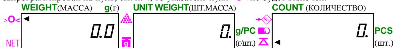
**q** Положите взвешиваемый груз на платформу. Указатель нуля **>O<** выключится, а стабильности **Δ** - сначала выключится, а затем включится вновь. На дисплее **WEIGHT** (МАССА) высветится показание массы груза (здесь: 2000,0 г).
