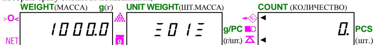
высвечиваемыми в течение ~ 3 сек (указатель суммирования  $\rightarrow S$  будет включен). Здесь на дисплее UNIT WEIGHT (ШТ.МАССА) высвечивается порядковый номер взвешивания, а именно № 1. Затем показание на дисплее UNIT WEIGHT (ШТ.МАССА) обнулится, а на других дисплеях останутся прежними.
