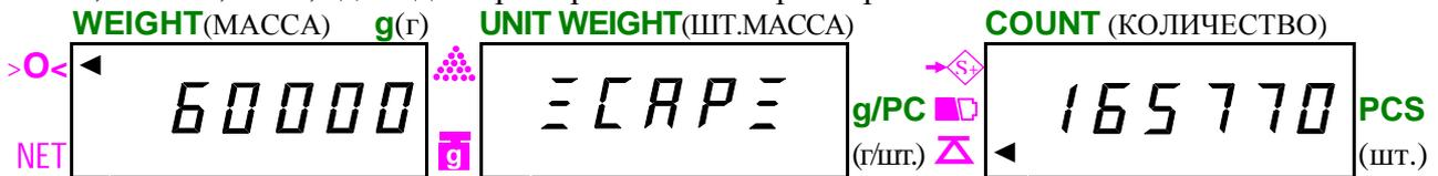
Если эту настройку изменять не нужно, нажмите клавишу **ENTER**, и произойдет переход к следующей настройке. В противном случае циклически переключайте параметр, нажимая клавишу **MOVE** до появления нужного параметра, например 30000,
