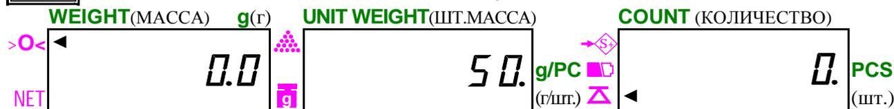
q Положите на платформу весов рабочую партию образцов. На дисплее **WEIGHT** (МАССА) высветится измеренная масса образцов, здесь 2000.0 г, и выключится указатель нуля >O<. На дисплее **COUNT** (КОЛИЧЕСТВО) указатель стабилизации  $\Delta$  сначала выключится, а затем включится вновь, и будет показан объем партии в штуках как частное от деления массы на штучную массу; результат округляется с точностью до целого.
