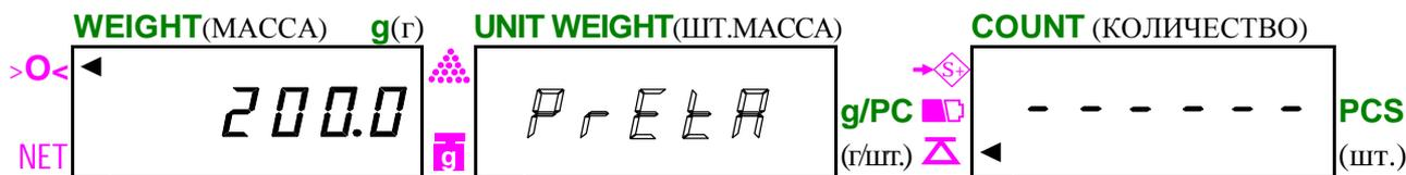
q и нажмите клавишу **P.TARE**. На дисплее **WEIGHT** (МАССА) высветится введенная масса тары со знаком минус и включится указатель **NET**, а на дисплее **UNIT WEIGHT** (ШТ.МАССА) высветится нулевое показание.
