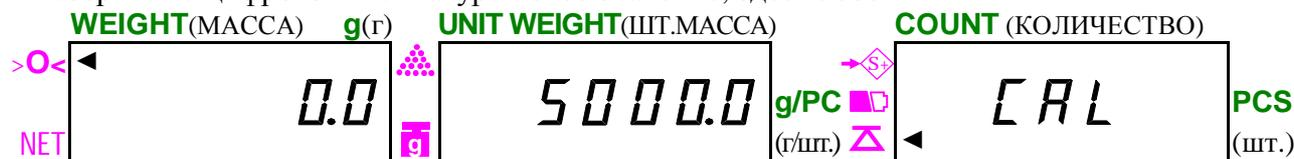
☐ Установите на платформу требуемую гирю или набор гирь, не делая больших пауз между приращениями. В процессе нагружения показание на дисплее **UNIT WEIGHT** (ШТ. МАССА) будет мигать, а в заключение весы перейдут в режим взвешивания, что означает завершение юстировки.
