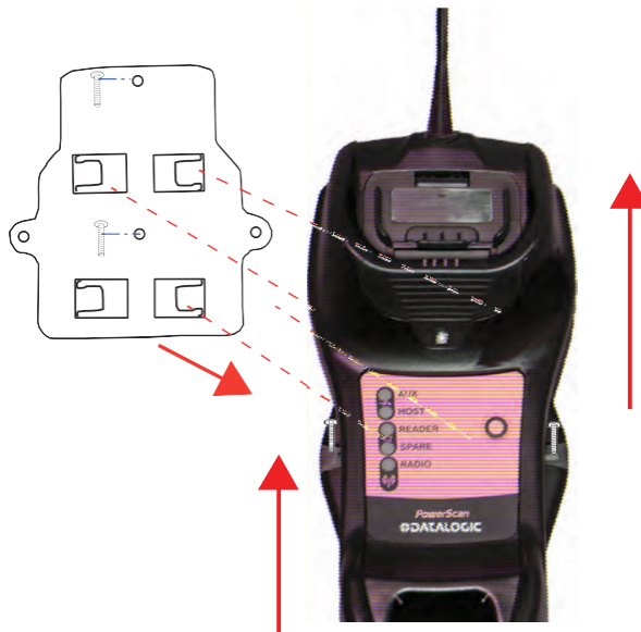
Рис. 4. Монтаж пластины на стене
